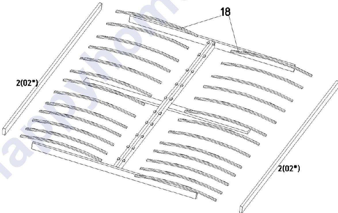
Собранное кроватное основание вставить в каркас кровати, соединив их между собой саморезами 3,5x32 через сквозные отверстия в кроватном основании. Опорный брусок 9 вкрутить во втулку в центральном поперечном бруске. Для удобства сборки рекомендуется поставить кровать в вертикальное положение головной спинкой вниз.
