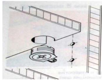
При вращении натяжного элемента в корпусе болт распирает отверстие и, тем самым, обеспечивает плотное соединение полки и боковой стенки с силовым замыканием.
