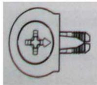
Возможно легкое вдавливание корпуса от руки . Благодаря углу затягивания 15 градусов отвертка может свободно вращаться в месте монтажа.
