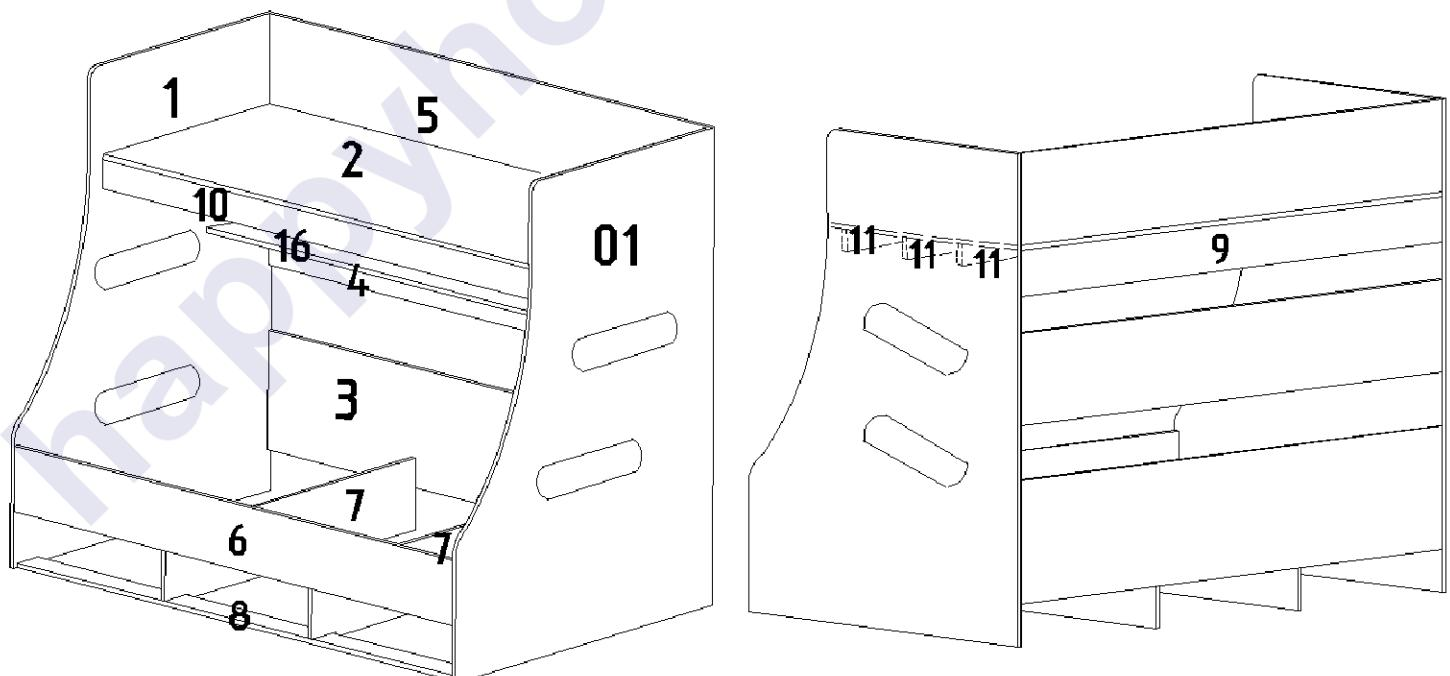
С помощью евровинтов 6,3x50 к бокам 1 и 01 прикрутить царгу 17, с планкой 10 соединить с помощью межсекционных стяжек.
