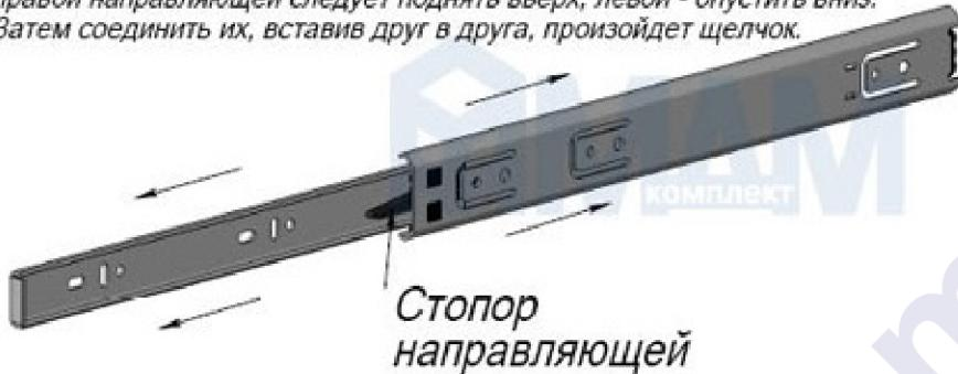
Рис. 4. Шариковая направляющая.
