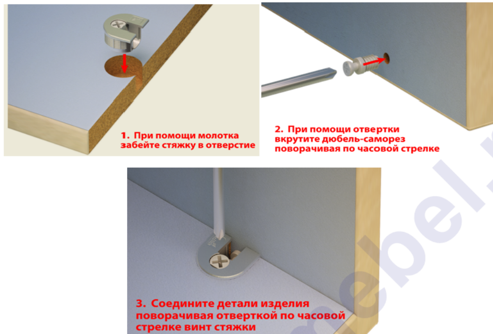
Рис. 1. Установка стяжек "Rafix"
