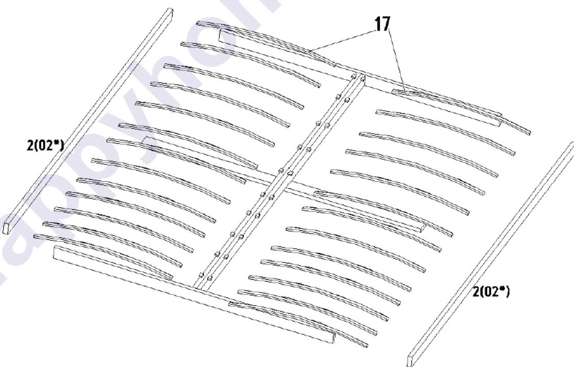
Собранное кроватное основание вставить в каркас кровати, соединив их между собой саморезами 3,5x32 через сквозные отверстия в кроватном основании. Опорный бруск 9 вкрутить во втулку в центральном поперечном бруске. Для удобства сборки рекомендуется поставить кровать в вертикальное положение головной спинкой вниз.
