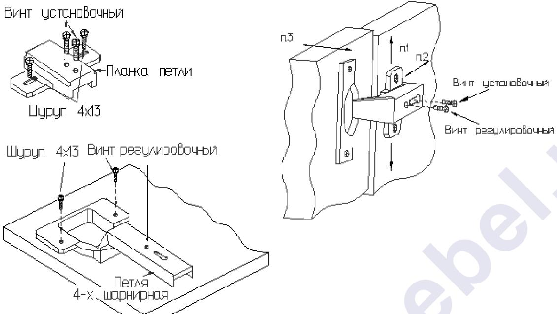
Рис. 5. Установка фасадов.
