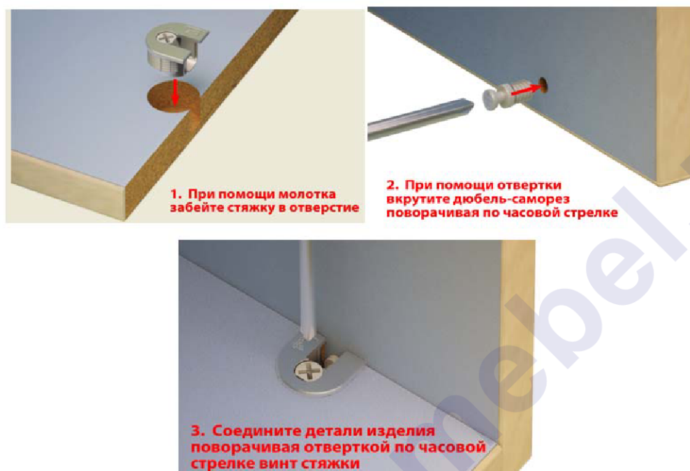
Рис. 1. Установка стяжек «Hetch»
