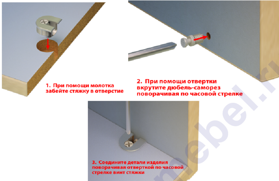
Рис. 1. Установка стяжек "Rafix"
