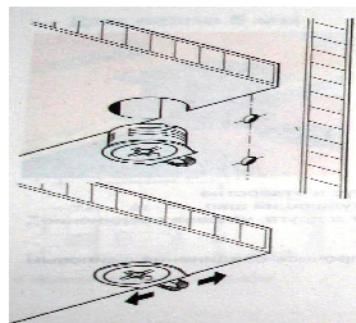
При вращении натяжного элемента в корпусе болт расширяет отверстие и, тем самым, обеспечивает плотное соединение полки и боковой стенки с силовым замыканием.
