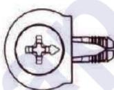
Возможно легкое вдавливание корпуса от руки. Благодаря углу затягивания 15 градусов отвертка может свободно вращаться в месте монтажа.
