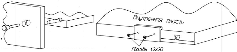
Рис. 2. Сборка при помощи евровинтов 6,3х50. Рис.3. Установка подпятников.
