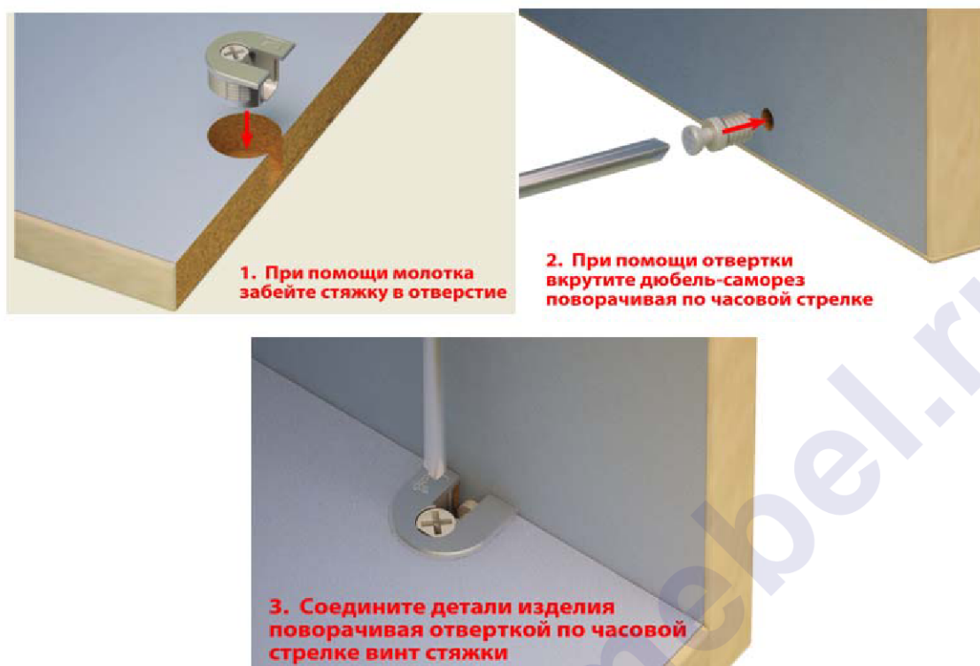
Рис. 1. Установка стяжек “Hetich”
