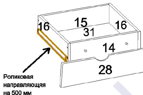
Роликовая направляющая на 50 мм
