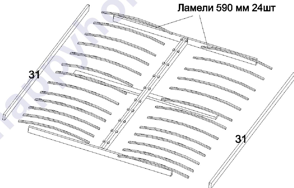
Собранное кроватное основание вставить в каркас кровати, соединив их между собой саморезами 3,5x35 через сквозные отверстия в кроватном основании. Установить опорный брусок со шпилькой по центру кровати. Для удобства сборки рекомендуется поставить кровать в вертикальное положение головной спинкой вниз.
