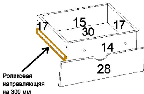
Роликовая направляющая на 30 мм
