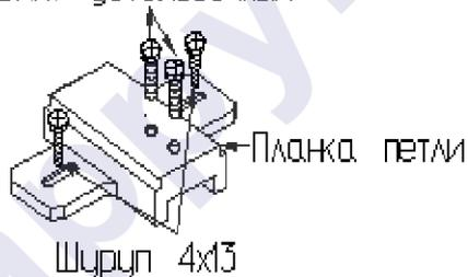
Шуруп 4x13 Винт регулировочный
