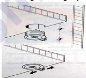
При вращении натяжного элемента в корпусе болт распирает отверстие и, тем самым, обеспечивает плотное соединение полки и боковой стенки с силовым замыканием.
