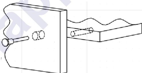
Рис. 1. Сборка при помощи евроинтов 6,3x50.
