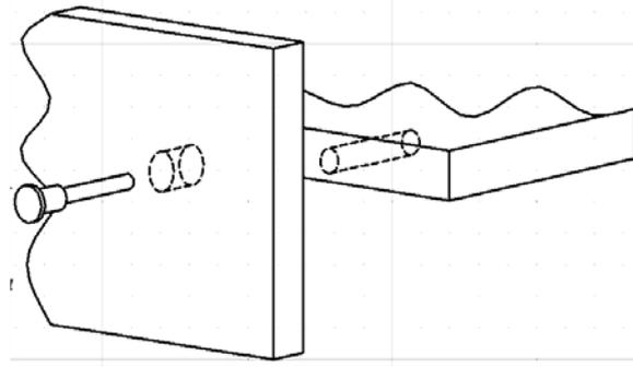
Рис. 2. Сборка при помощи евровинтов 6x50.
