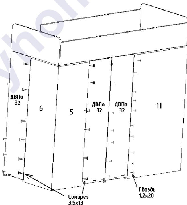
Рис. 9. Установка задних стенок.
