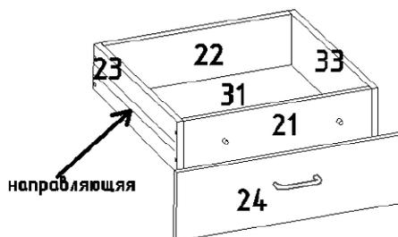
Рис. 10. Сборка ящика.
