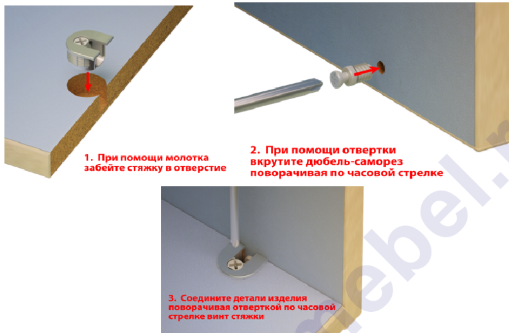
Рис. 1. Установка стяжек "Rafix"
