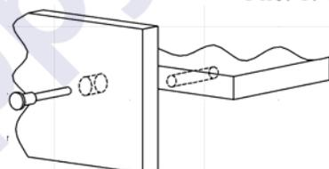
Рис. 2. Сборка при помощи евровинтов 6,3x50.
