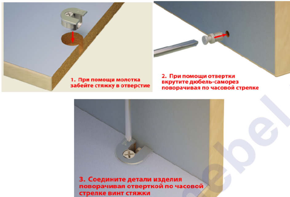
Рис. 1. Установка стяжек «Netich»
