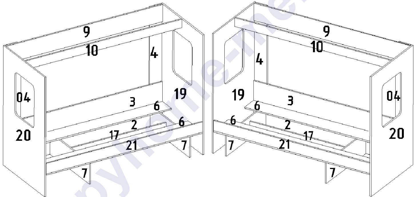
Установить дно кровати 1. С помощью стяжек “Onefix” установить заднюю царгу 22, спинки 24 и 25. С помощью евровинтов 6,3x50 прикрутить царгу 23, затем установить царгу 8. С помощью стяжек стяжек “Onefix” к бокам 19 и 20 присоединить планки 5 и 05, с царгами 21 и 8 соединить межсекционными стяжками.
